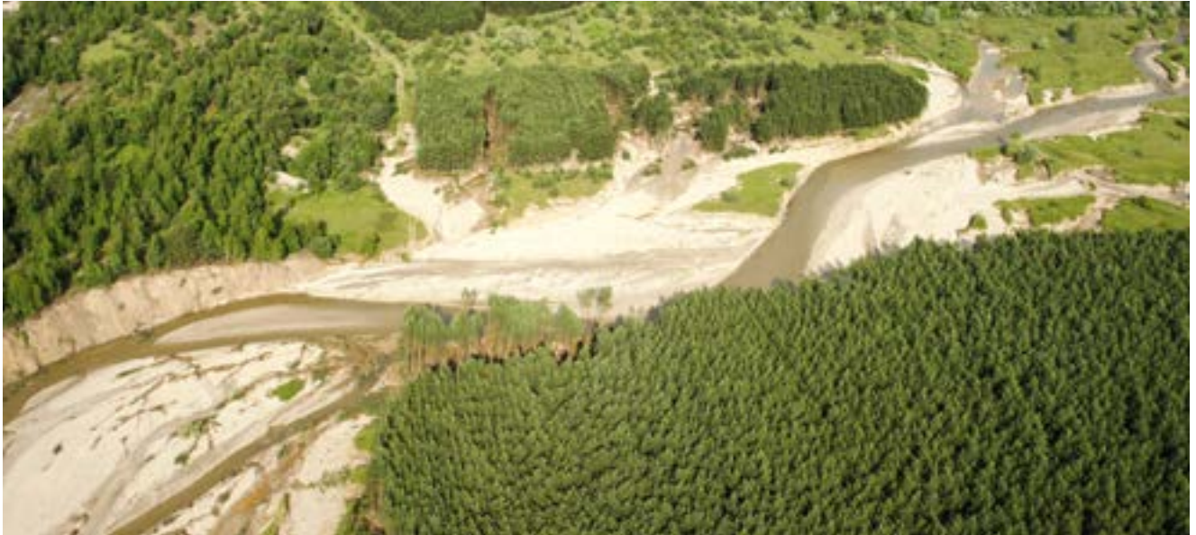
Durchbruch vom Seelhausener See in den Goitzschesees nach der Hochwasserflut im Juni 2013. Foto: BUNDstiftung
